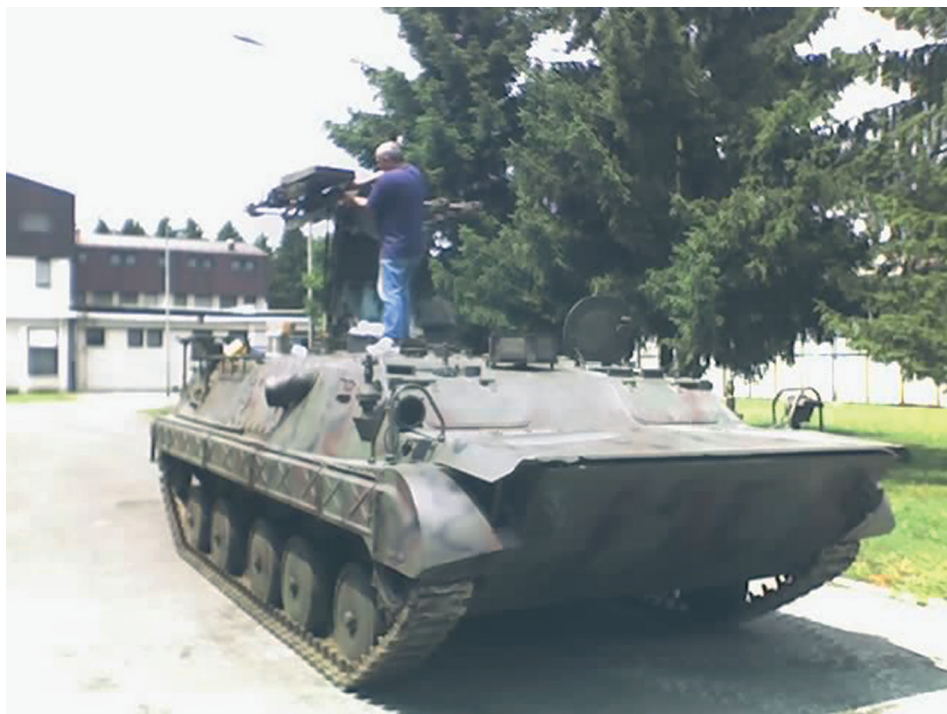
Sl. 3.: Prototip Končareve 'Strele' na oklopnom transporteru Fabrike motora Sarajevo (Famos). Snimljeno za vrijeme tehničkog pregleda u Zrakoplovno-tehničkom zavodu (ZTZ) (danas: Zrakoplovno-tehnički centar, ZTC) u Velikoj Gorici. (Izvor slike: arhiva Dalibora Burnača)
