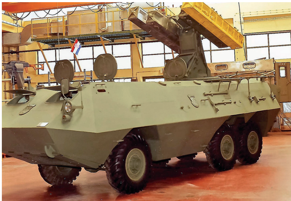
Sl. 8.: Prototip modernizirane Strije 10 CRO na kotačima u radionici SUS-a, montaža lansera. (Izvor slike: arhiva Borisa Gvozdena)
