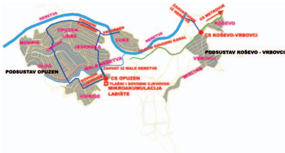
Navodnjavanje u Donjoj Neretvi - shema podsustava
