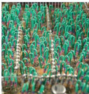
Sl. 49.: PCB s tranzistorima i diodama (Toshiba BC-1213, 1969.)
