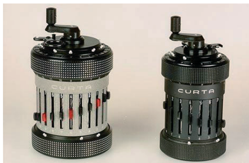
Sl. 27.: Dvije izvedbe ručnog mehaničkog stroja Curta: Curta I (1947. – 1970.) s kapacitetom 8/6/11 znamenki (desno) i Curta II (1953. – 1971.) s kapacitetom 11/8/15 znamenki (lijevo)
