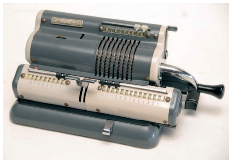
Sl. 28.: Računski strojevi tipa pinwheel – lijevo: Calcorex Tvornice računskih strojeva Zagreb (unos brojeva s pomoću polugica); desno: Facit C1-13 (unos brojeva preko Daltonove tipkovnice)
