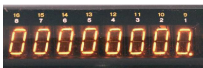
Sl. 58.: Burroughs Panaplex II ekran, neonski izboj na hladnoj katodi (Sanyo ICC-82D, 1971.)
