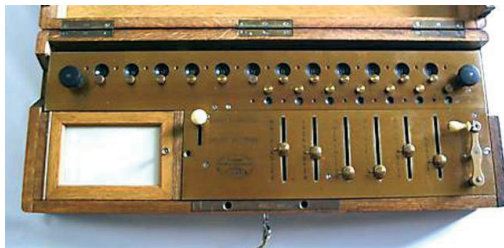
Sl. 26.: lijevo: Leibnizov računski stroj (1672.); desno: Thomasov Arithmometer (1820.)
