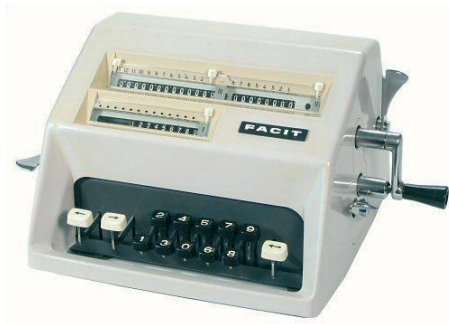
Sl. 28.: Računski strojevi tipa pinwheel – lijevo: Calcorex Tvornice računskih strojeva Zagreb (unos brojeva s pomoću polugica); desno: Facit C1-13 (unos brojeva preko Daltonove tipkovnice)
