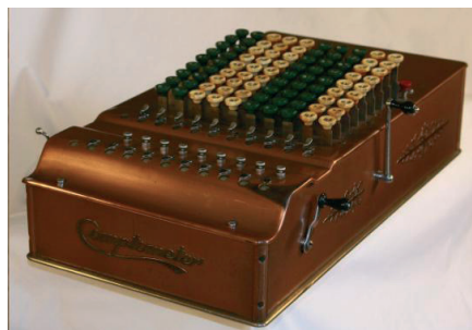
Sl. 22.: Uredske zbrajalice s punom tipkovnicom – lijevo: zbrajalica tvrtke Burroughs, desno: zbrajalica Comptometer tvrtke Felt&Tarrant
