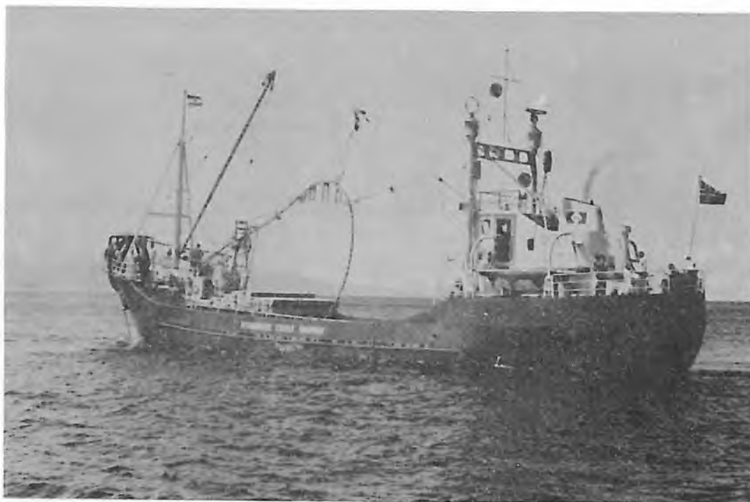
Sl. 7. 22. NORVEŠKI BROD M/S »Carioca« POLAŽE KABEL 110 kV IZMEĐU OTOKA BRAČA I HVARA
