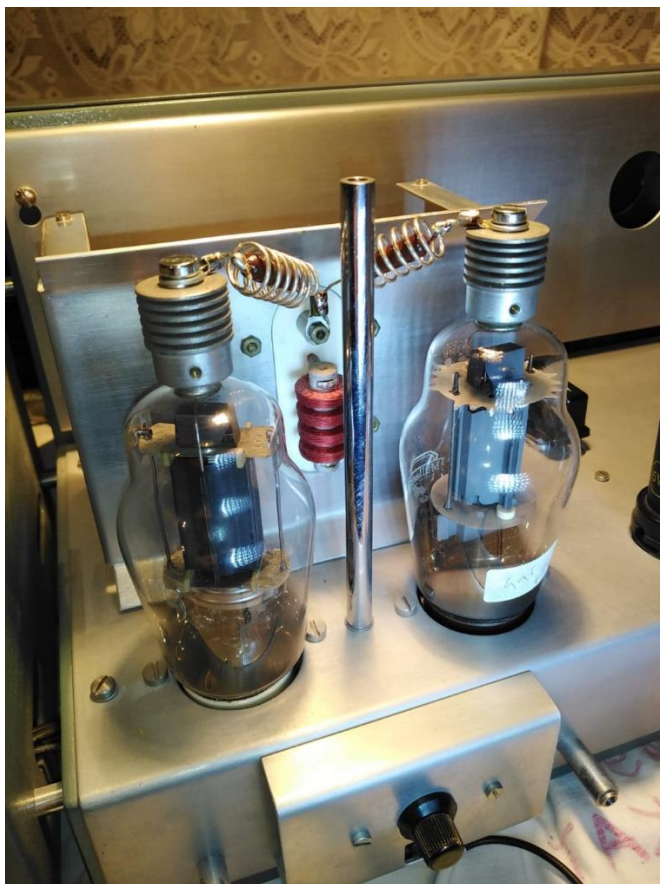
Sl. 16.: Izlazni stupanj 2x807 sa supresorima i VF prigušnicom
