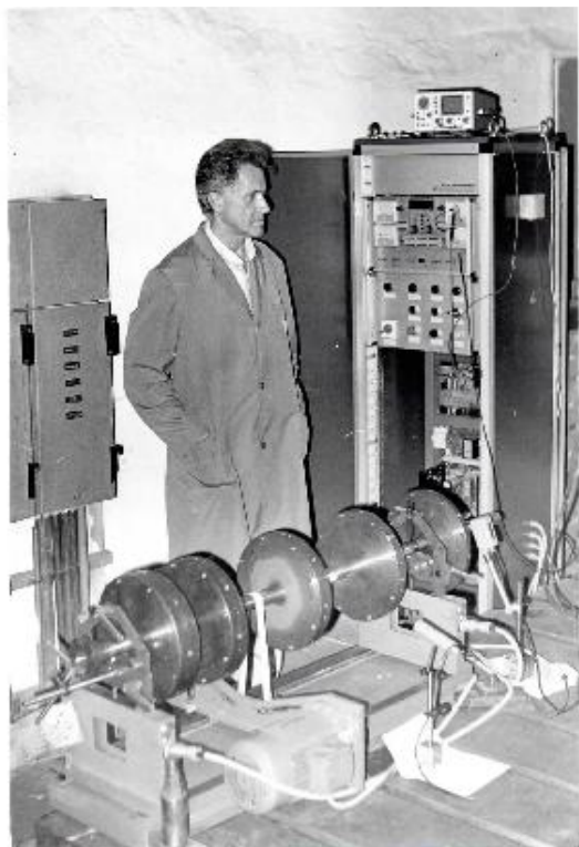
Sl. 5. Razvoj horizontalnog stroja za balansiranje u laboratoriju 1986.
