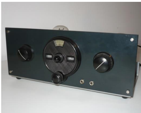
Sl. 7.: Savinov dvocijevni audion
