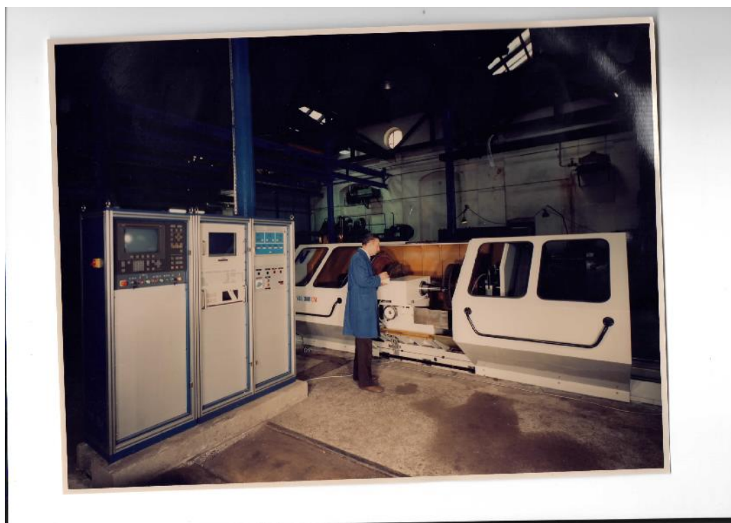
Sl. 6. Horizontalni stroj za balansiranjem tip SBH 3000 CNC, firme ENIN Karlovac (slijednica Instituta Jugoturbine) isporučen 1994. Gredelju Zagreb, za automatsko balansiranje vagonских osovina s kotačima
