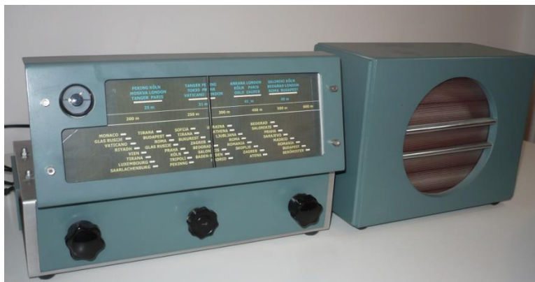
Sl. 11.: Savinov četverocijevni superheterodinski prijemnik sa zvučnikom
