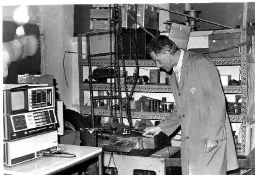
Sl. 4. Ispitivanje lopatica FFT metodom u laboratoriju 1986.
