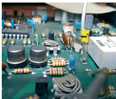
Sl. 18.: RIZ-ovi tranzistori u generatoru funkcija MA 3735
