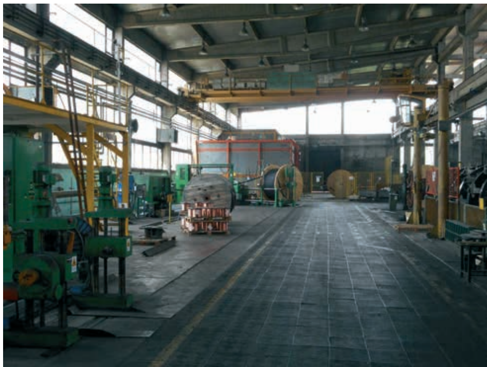
Slika 8.: Elektrotehnički institut Rade Končar razvio je za tvornicu Novkabel (Novi Sad, Srbija) Faradayev kavez izmjera 10\text{ m} \times 7\text{ m} \times 4,5\text{ m} za ispitivanje izolacije kabela metodom parcijalnog izbijanja. Na slici, u dnu tvorničke hale, vidi se Faradayev kavez i kablanski bubnjevi pripremljeni za ispitivanje.
