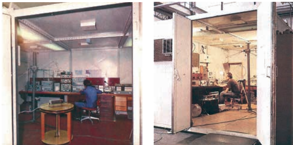
Slika 2.: Faradayev kavez s mjernom opremom; izmjere kaveza 5,25 \text{ m} \times 3,5 \text{ m} \times 2,6 \text{ m} ; gušenje elektromagnetskog polja: veće od 80 dB u području frekvencija od 10 kHz do 100 kHz i veće od 100 dB u području od 100 kHz do 1 GHz
