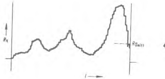
Sl. 5-1 Karakterističan tok kontaktnog otpora uzduž lijevanog štapa
