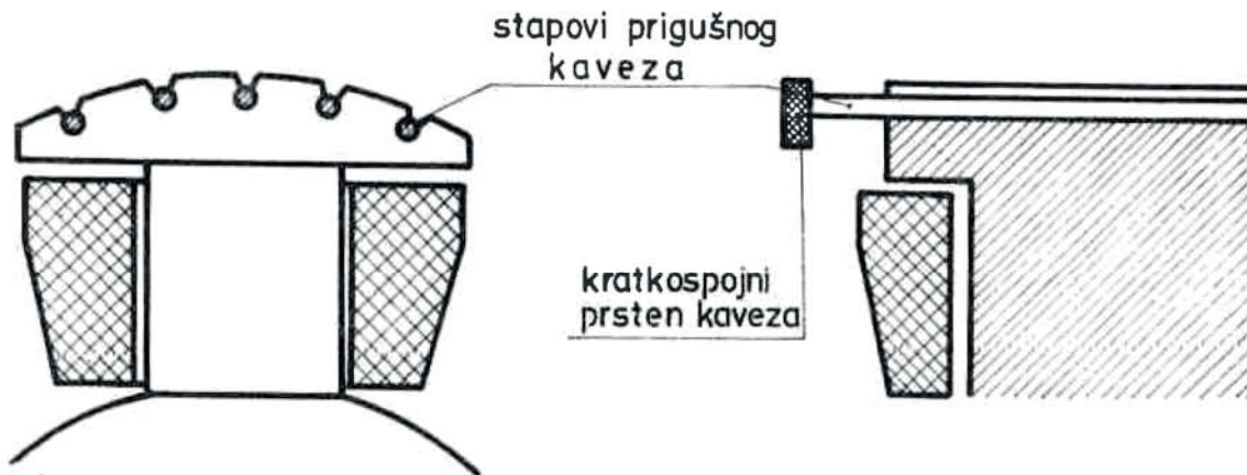
Sl. 3.7-05 Prigušni kavez kod sinhronog stroja s izraženim polovima
