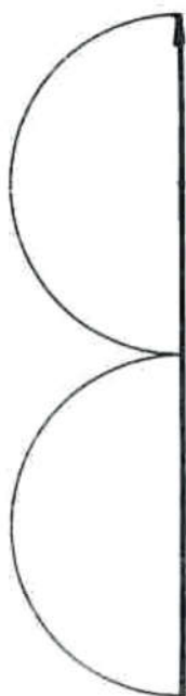
Sl.2.3-05 Vektorska suma napona svih svitaka u slučaju beskonačnog broja utora
