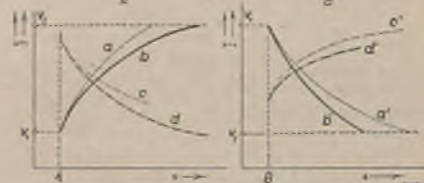
Sl. 6. A: ubrzanje, B: smanjenje brzine; v : brzina, i : struja, s : put; a (a'): brzina kod stalnog nadnapona, b (b'): brzina kod stvarnog napona, c (c'): struja kod nadnapona, d (d'): struja kod stvarnog napona.
