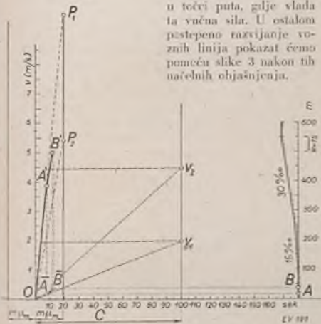
Sl. 3. Konstrukcija voznih linija v-t i s-t (vozni dijagram).
