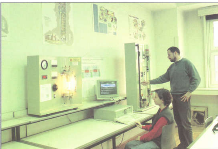
Demonstracijski uređaji za simuliranje termo- hidrauličkih procesa u nuklearnom reaktoru
