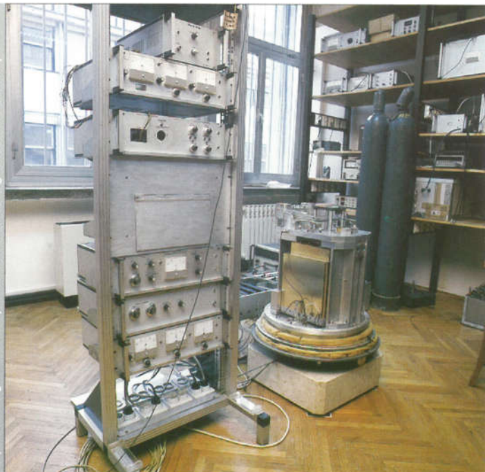
Naponska vaga ETF-84 u primarnom elektromagnetskom laboratoriju
