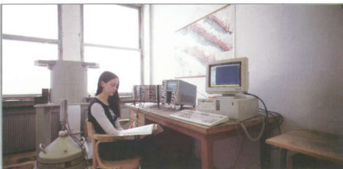
Nuklearni laboratorij: germanijski detektor visokog razlučivanja za gama spektrometriju
