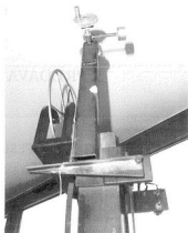
Sl. 5.2.: Detalj uređaja za mjerenje slobodnog pada. Vidi se klupicu u početnom položaju, a na njezin se kraj postavlja željena kuglica pomoću odabrane dimenzije koja će izvoditi slobodni pad u zraku na normalnom tlaku.
