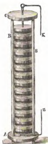
Prva baterija, Voltin stup od niza pojedinih članaka
