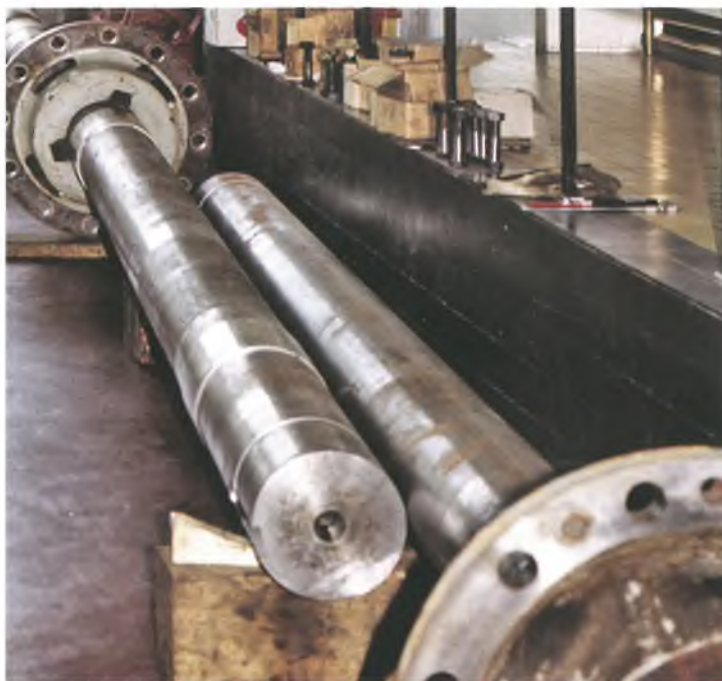
Turbinska vratila zamijenjena su na sva tri agregata
