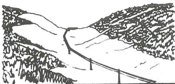
Loše položen vod Slika 2.10.
