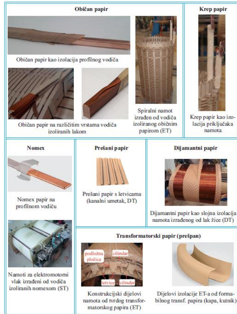
Sl. 7.2. Primjeri papirne izolacije u transformatoru
