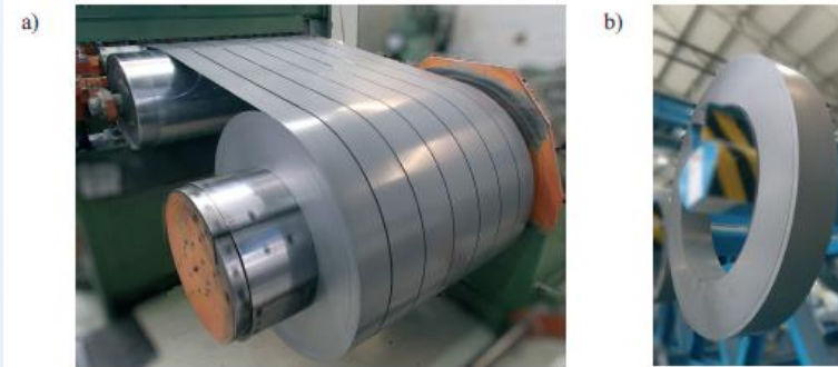
SL 5.15. a) Proces uzdužnog rezanja bale lima na kolutove i b) jedan uzdužno izrezani kolut lima
