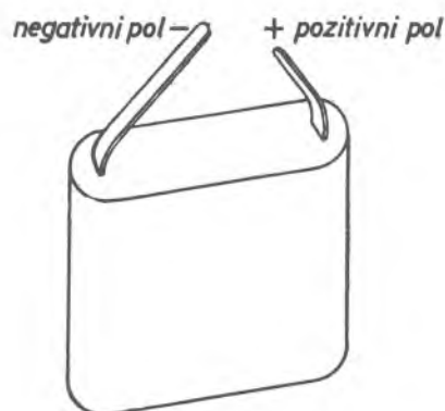
Sl. 1.4. Kraći jezičak je pozitivni pol, a dulji negativni pol baterije.
