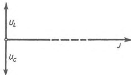
Sl. 2.69. Kad se pojedinačni naponi u serijskom spoju induktiviteta i kapaciteta na stanovitoj frekvenciji (rezonantnoj) izjednače, razlika otpora jednaka je null, pa je struja neizmjereno velika.
