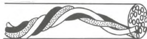
Sl. 2.81. Preplitanjem izoliranih žica postiže se da visokofrekventna struja teče kroz sve žice.
