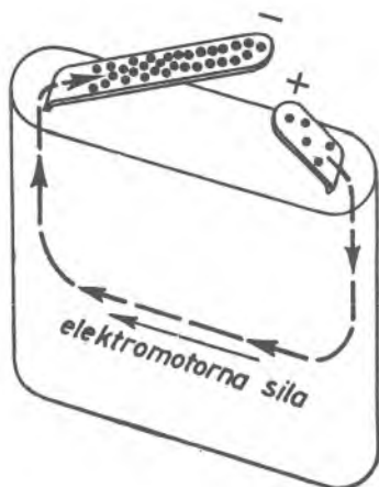
Sl. 1.3. Elektromotorna sila siše slobodne elektrone iz kraćeg jezička baterije i tlači ih u dulji jezičak.
