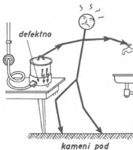
Sl. 1.47. Na napon rasvjetne mreže može zbog neispravnosti doći i vanjsko kućište kuhala pa je istodobni doticaj kuhala i slavine opasan po život.
