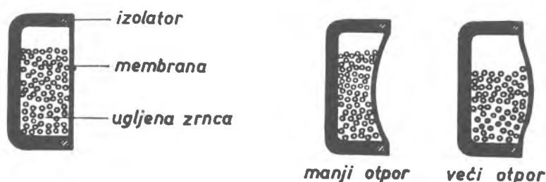
Sl. 4.62. Presjek ugljenog mikrofona; desno: titranjem membrane ugljena se zrnca stlaču i razmiču, pa njihov otpor postaje manji i veći.
