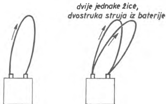
Sl. 1.17. Kroz dvije jednake žice spojene paralelno i priključene na istu bateriju teći će iz baterije dva puta jača struja.
