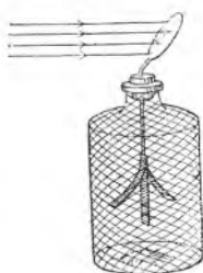
Sl. 174. Ultraljubičaste zrake ispraznjuju elektroskop.
