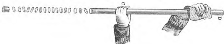
Sl. 60. Staklena se cijev razlama od titranja.
