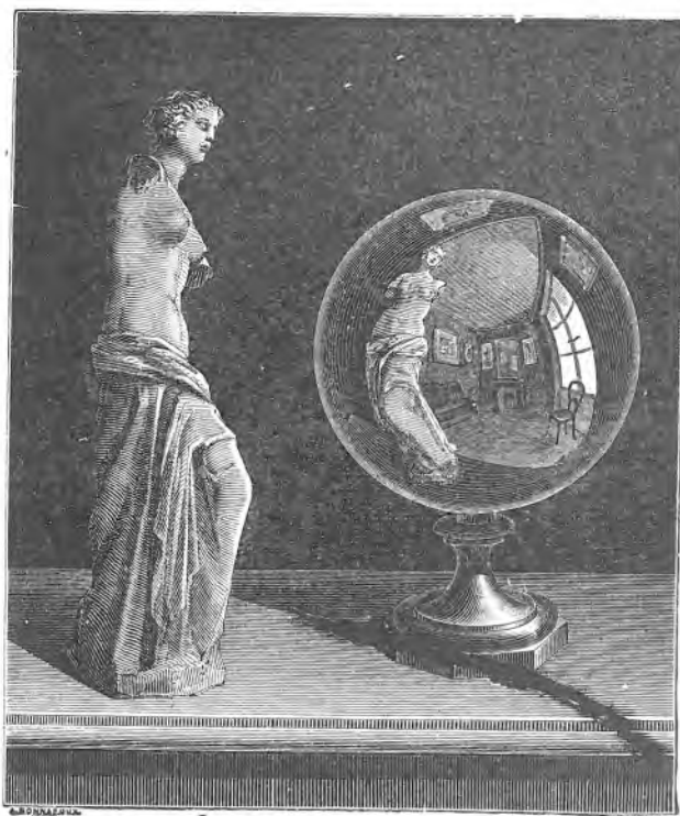
Sl. 106. Pupčasto zrcalo; virtuelna upravna slika, manja od predmeta.
