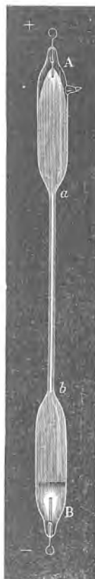
Sl. 144. Geisslerova cijev.
