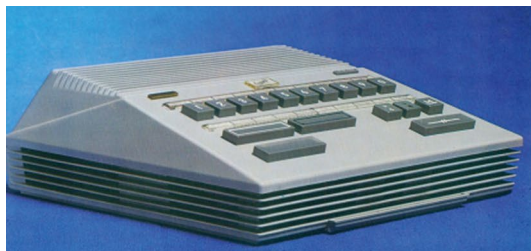
Slika 5.: Interfonski aparat i interfonske centrale (ASE 432 kapaciteta do 20 i ARD 451 do 100 korisnika)
