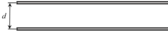
Slika 21.6. Zračni dvožični elektroenergetski prijenosni vod
