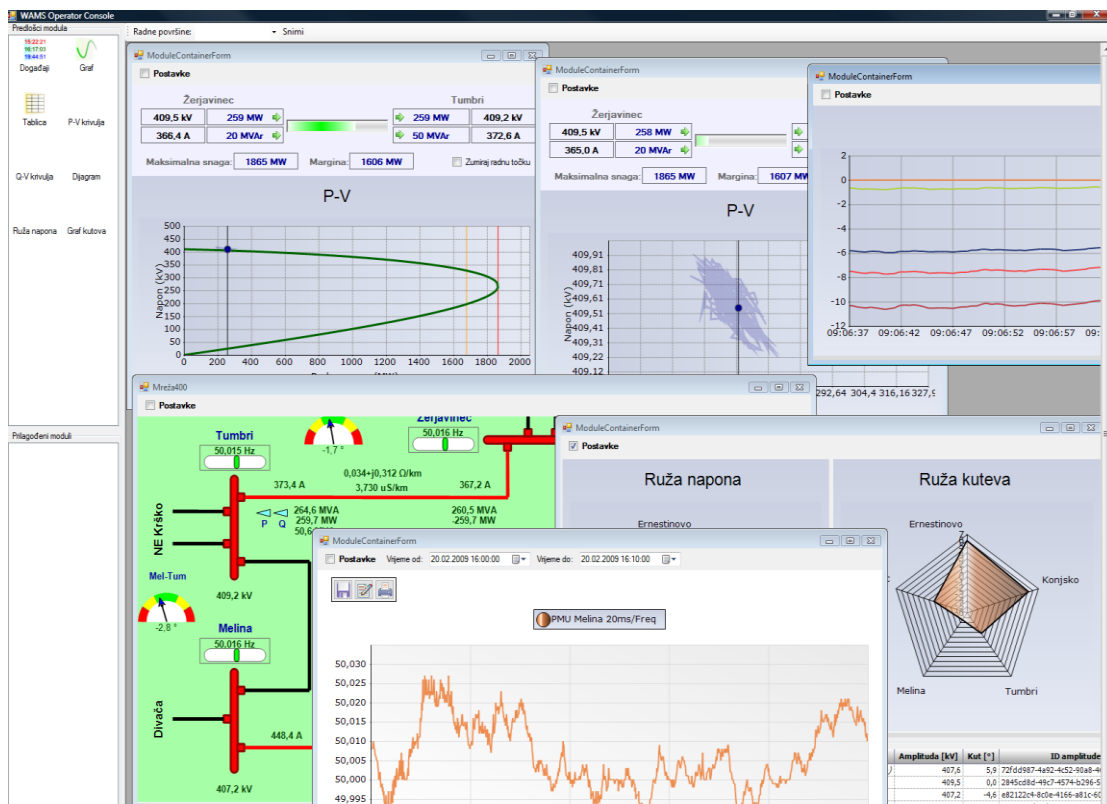
Slika 2.1. Prikaz operatorske konzole modernog WAMPAC sustava – SynchroShield (Preuzeto od strane Hrvatskog operatora prijenosnog sustava)
