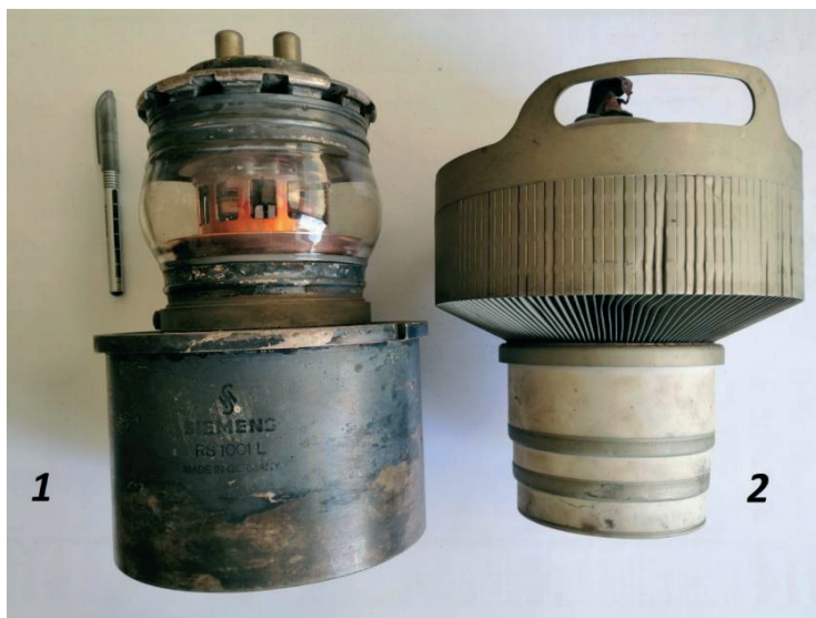
Sl. 29.: Siemens RS1001L (1) i EIMAC 8171 (2), u usporedbi s kemijskom olovkom radi predodžbenja veličine
