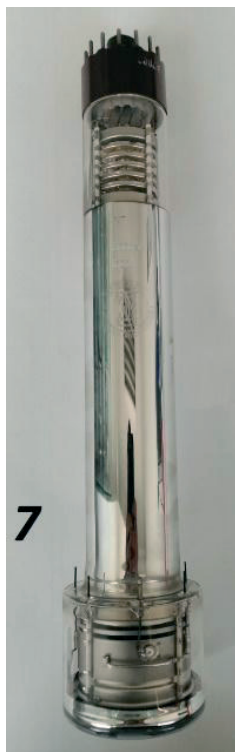
Sl. 3.: Vakuumska cijev orthicon (English Electric Valve Co. Ltd.) 7293 (B7887)
