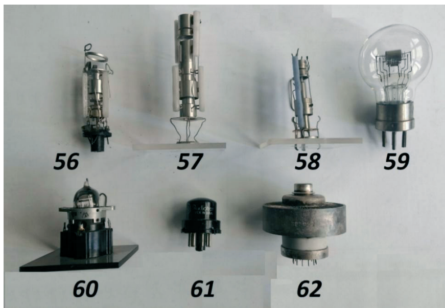
Sl. 15.: Dijelovi elektronskih cijevi (56), (57) i (58), Philips D VI (59), Telefunken (???) Wehrmacht (60), Radiotron RCA 12 H6 (61), Eimac DK BD 2092 (62)
