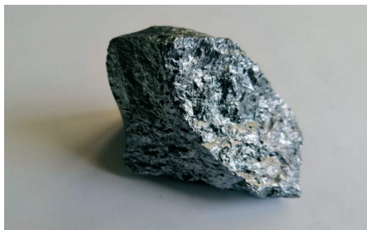
Sl. 20.: Kristal silicija – sirovina za proizvodnju poluvodičkih elektroničkih komponenti
