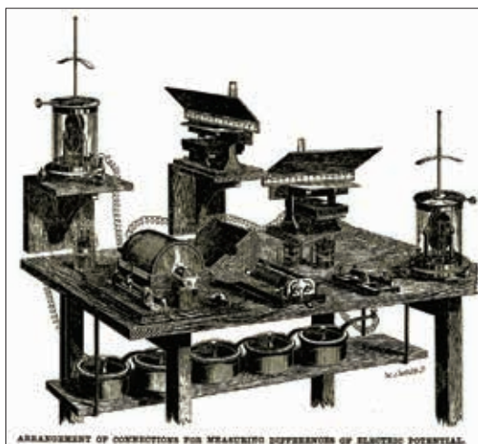
5 b) Postav za mjerenje razlike potencijala 8 iz 1873.
