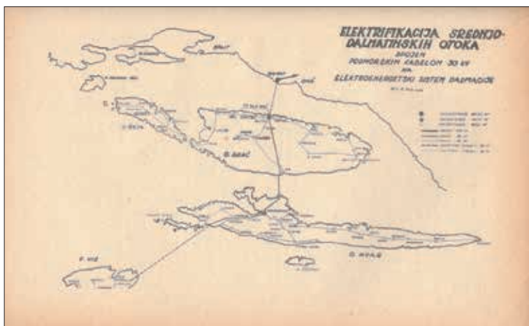
Slika 9. Plan elektrifikacije srednjodalmatinskih otoka spajanjem s podmorskim kabelom 30 kV na elektroenergetski sistem Dalmacije (preneseno iz Bračkog zbornika 1954., br. 2, 199)
